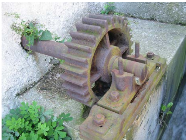
Slika 10: Zobnik, ki je bil zunaj povezan s kovinskim zobnim kolesom in vodnim kolesom, je prenašal vrtenje na dolgo pogonsko os v notranjosti Zalokarjevega mlina, avgust 2002.
