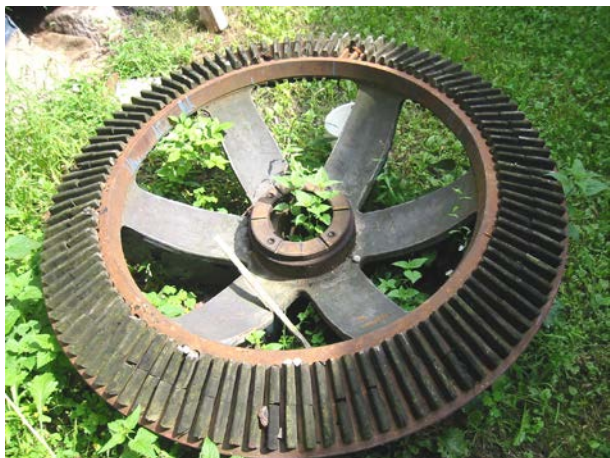
Slika 123: Zobato kolo z lesenimi palci, ki je bilo vgrajeno v vrhnji del prve turbine, avgust 2002.
