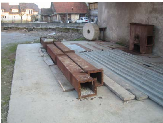
Slika 72: Opuščene štirikotne cevi za elevatorje, ki so prenašali žito v silos, marec 2002.
