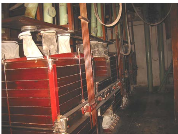
Slika 21: Planska sejala, ki so nahajala na tretji etaži, so moko je nadaljevala pot na drugo etažo, zdrobi pa so se vrnila na prvo etažo v ponovno mletje, Nastranov mlin, avgust 2002.
