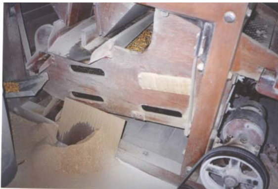
Slika 63: Čistilni stroj, ki iz rži izloči prinesi: koruzo, pleve, prah in druge prinesi, marec 2000.
