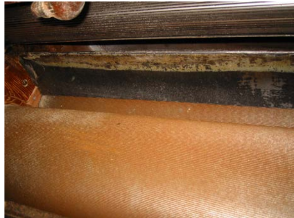
Slika 15: Pogled v valjni stroj: zgoraj dovajalni valj sipa žito med dva kovinska valja. Ta valja se vrtita drug proti drugemu in tako meljeta žito. Nastranov mlin, avgust 2002.
