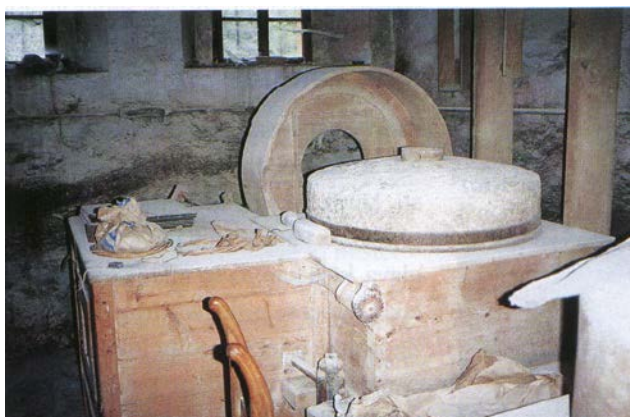
Slika 12. Odrpna mlinska naprava. Vidi se zgornji mlinski kamen. Povzeto po prilogi Pil plusa, 2002.
