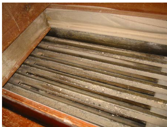
Slika 22: Notranjost planskih sejal. Spodaj so svilene mrežice, skozi katere se je moka presejala. Kar se je ujelo v korita, se je vrnilo v ponovno mletje, Nastranov mlin, avgust 2002.
