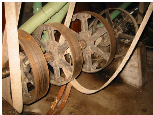
Slika 11: Številne jermenice in jermena na transmisiji, Nastranov mlin na Homcu, avgust 2002.
