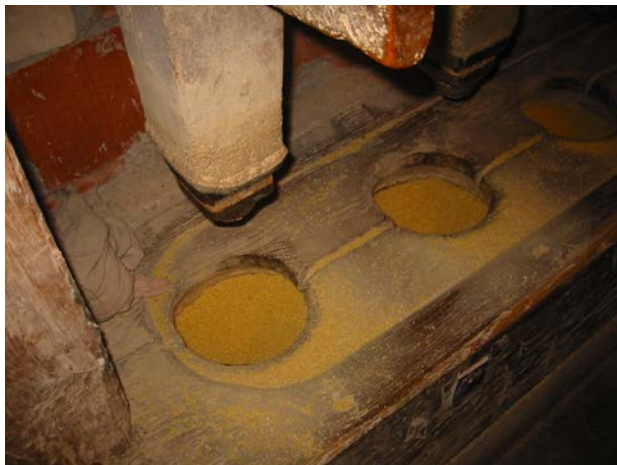
Slika 49: Drogovi padajo v kovinske skodelice, vdolbene v leseno bruno, in stopajo ali phajo proso. Stope v Kernovem mlinu v Zalogu pri Cerkljah, november 2002.
