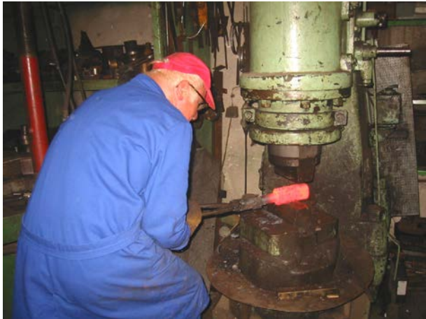
Slika 103: Kovač Janez Juhant je pod težkim kovaškim kladivom oblikuje žarečo kovino, avgust 2002.
