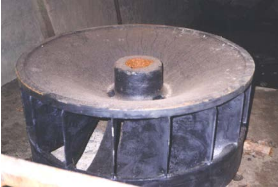
Slika 124: Rotor ali tekač, preko katerega teče voda z vrha in pri odtekanju povzroča vrtenje, marec 2000.
