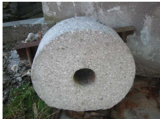
Slika 13: Mlinski kamen iz naravnega kamna (konglomerata) za Osolinovim mlinom, marec 2002.
