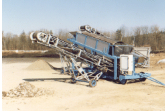
Slika 99: Sejalna naprava s podajalnimi trakovi peska, zemlje in podobnih materialov, povzeto po predstavitvi na spletni strani, avgust 2002.
