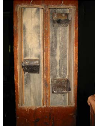
Slika 18: Notranjost elevatorja za moko. Skodelice na jermenih prenašajo moko, Nastranov mlin, avgust 2002.
