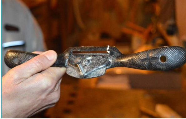
Slika 28: Rezilnik je orodje z rezilom in dvema ročajema za obdelovanje lesa.
