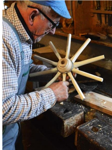
Slika 21: Pri delu je zelo spreten - vstavljanje špic v pesto.
