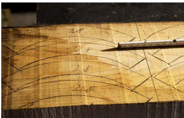
Slika 32: Tesarski svinčnik, meter in šablona so bili potrebni, da je na les zarisal dele platišč.
