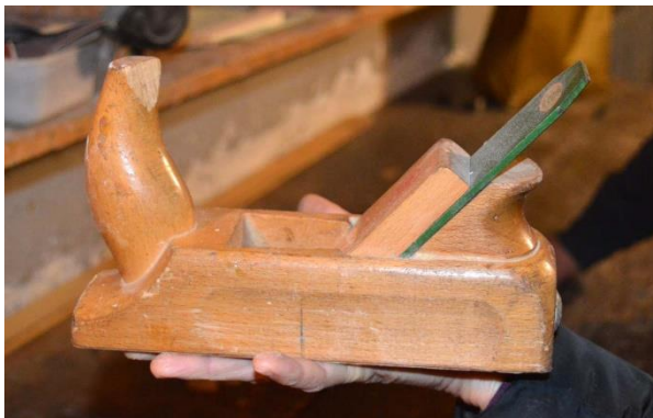
Slika 30: Oblič, orodje za glajenje lesa.
