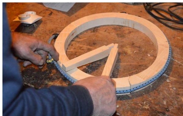
Slika 33: Pripravljanje špic. Dele platišča je kolar povezal z močno gumico.
