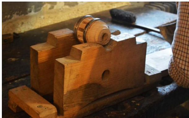
Slika 15: Pesto, osrednji del kolesa, kolar postavi v posebno stojalo.
