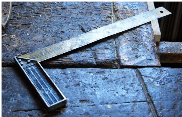
Slika 24: Kotomer (»vinkel«) je stalni kolarjev pripomoček.
