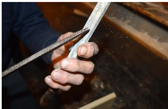
Slika 27: Pila z vzporednimi grebeni po površini za obdelovanje kovinskih predmetov.
