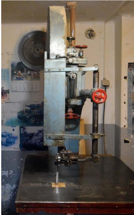
Slika 34: Tračna žaga je danes Pergarjev zelo pomemben pripomoček. Janez Pergar pripominja: »Ko pa sem se učil za kolarja, nismo imeli nobenega orodja, le pilo in žago.«
